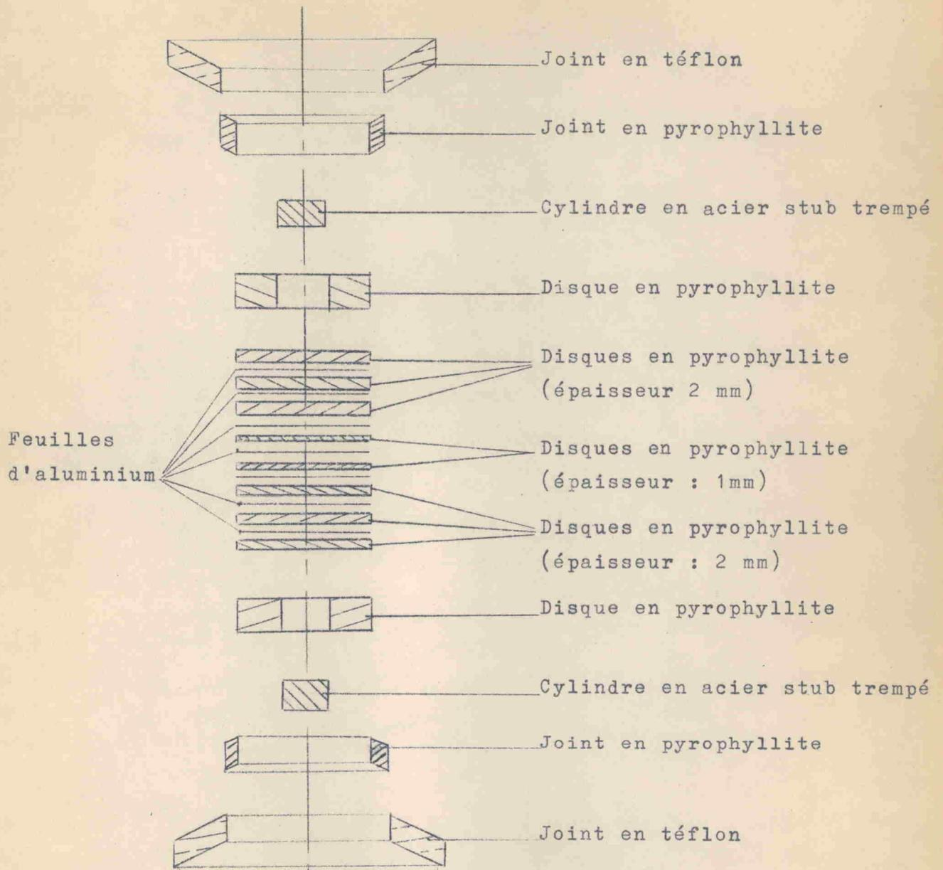
Fig. 3 -5 Montage des disques pour l'essai de mise en évidence des déformations.
